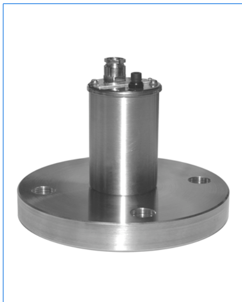
Schauglasleuchte miniLUX STERI-LINE, Typ BKVLR 20 HDA, 20 W, 24 V, aufgebaut auf metallverschmolzenem Schauglasflansch für die Steriltechnik, DN 50
