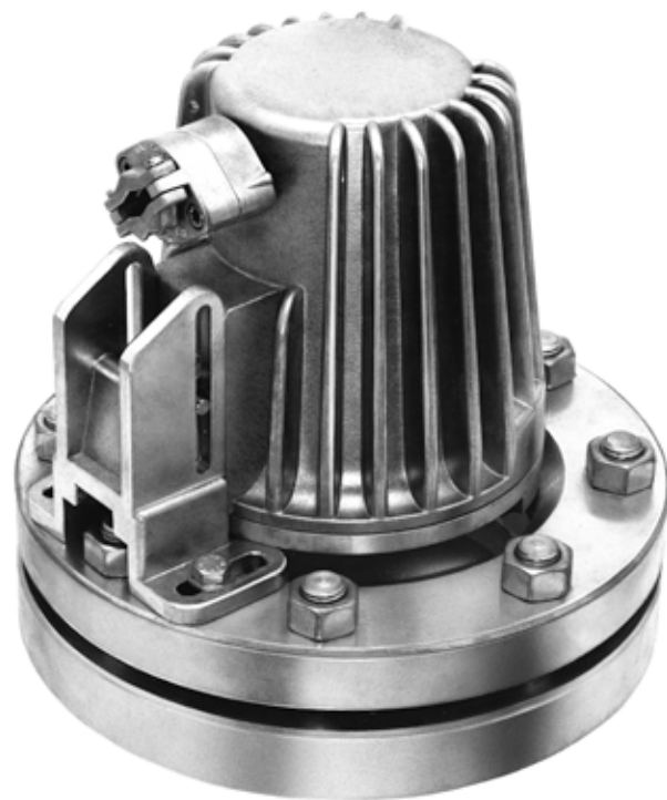
Typ F 20 dHSchU, Ex d IIC T5, Ex tD A21 IP65 T95°C, Ex II 2 G + D, Halogenglühlampe, 230 V, 20 W, eingebauter Timer «U», auf Schauglasarmatur nach DIN 28120, DN 125, PN 10, mit Kippscharnierbefestigung «Sch»
