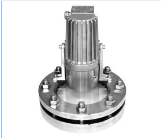
Typ HEL 35 deHSchB, Ex de IIC T4, Ex tD A21 IP65 T130°C, Ex II 2 G + D, 230 V, 35 W, Halogenausführung, mit Blendschutz «B», auf Schauglasarmatur nach DIN 28120, DN 150, PN 6, in Anordnung «Licht- und Sichtglas».
