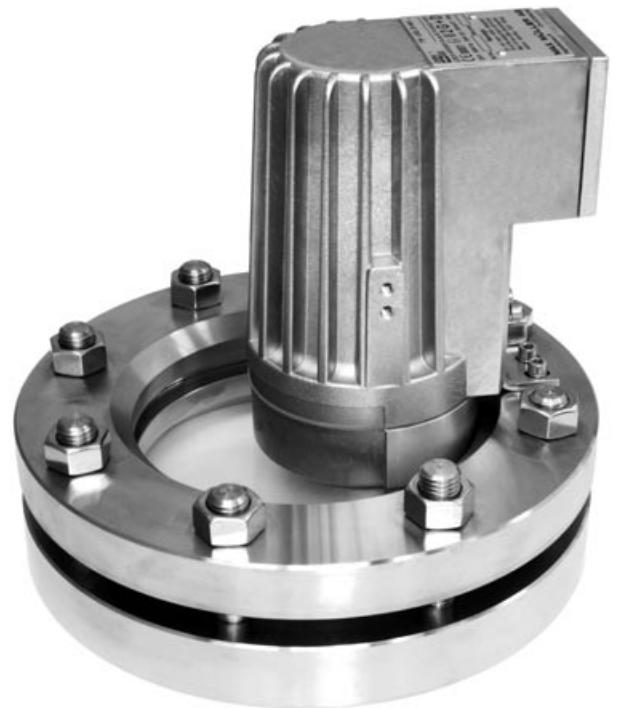
Typ HEL 50 deHW, Ex de IIC T3, Ex tD A21 IP65 T195°C, Ex II 2 G + D, 230 V, 50 W, Halogenausführung, auf Schauglasarmatur nach DIN 28120, DN 125, PN 10. Einsatz als Anordnung «Licht- und Sichtglas».
