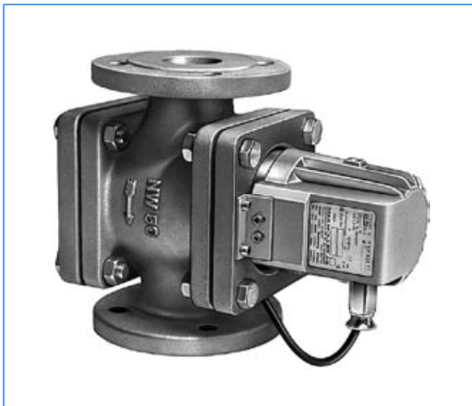
Typ FKEL 5 dH WM, Ex d IIC T6, Ex tD A21 IP65 T80°C, Ex II 2 G + D, 230 V, 5 W, mit Opalglas «M» auf Durchfluss-Schauglasarmatur NW 50.
