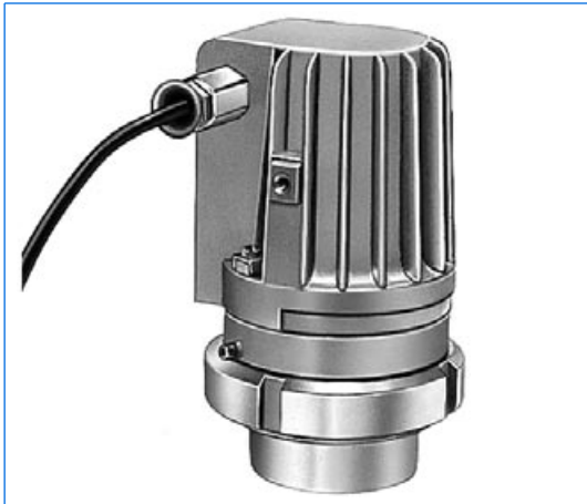
Typ FKEL 20 dH R, Ex d IIC T4, Ex tD A21 IP65 T130°C, Ex II 2 G + D, 230 V, 20 W, Halogenausführung, auf Schraub-Schauglasarmatur ähnlich DIN 11851, DN 65, PN 6. Befestigung über Einsteckbördel «R».
