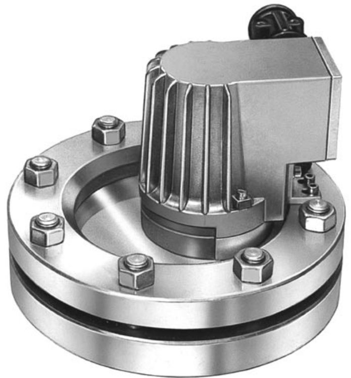
Typ KEL 20 deH W, Ex de IIC T4, Ex tD A21 IP65 T130°C, Ex II 2 G + D, 230 V, 20 W, Halogenausführung, auf Schauglasarmatur nach DIN 28120, DN 125, PN 10. Einsatz als Anordnung «Licht- und Sichtglas».
