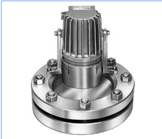
Typ KL 100 H Sch B, 24 V, 100 W, mit Blendschutz «B», auf Schauglasarmatur nach DIN 28120, DN 150, PN 10, in Anordnung «Licht- und Sichtglas»
