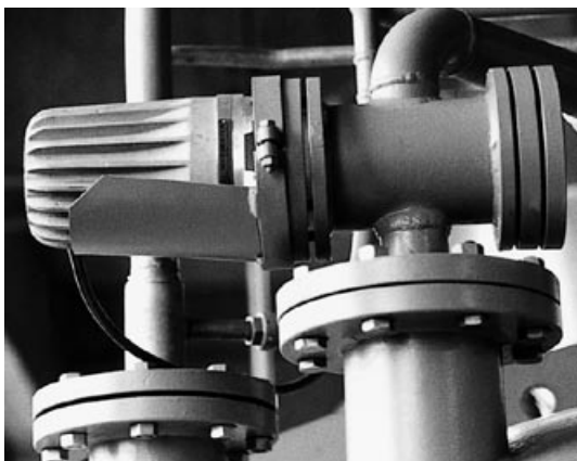
CHEMLUX® Schauglasleuchte Typ L 20 deH M sp, 20 W, 24 V, Ex de IIC T5, Ex tD A21 IP65 T95°C, Ex II 2 G + D, mit Opalglasscheibe «M» montiert auf einem Durchfluss-Schauglas
