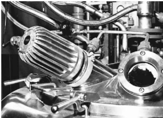
CHEMLUX® Schauglasleuchte Typ L 20 deH Sch, 20 W, 230 V, Ex de IIC T5, Ex tD A21 IP65 T95°C, Ex II 2 G + D, mit Kippscharnierbefestigung «Sch» auf einem Schauglas einer vertikalen Zentrifuge montiert
