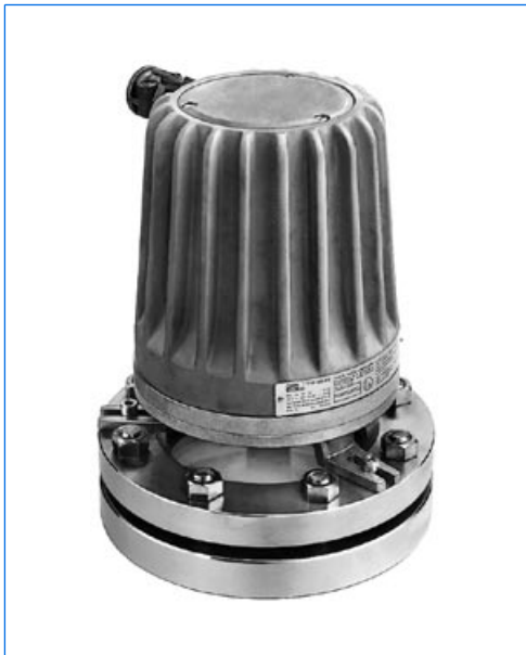
Hochleistungs-Schauglasleuchte Typ 100 deHN, 100 W, 24 V, Ex d e IIC T4 Gb, Ex t IIIC T130°C Db IP67, Ex II 2 G + D, mit Normfussbefestigung «N» montiert auf Schauglasarmatur nach DIN 28120, PN 10, DN 125
