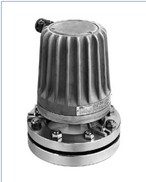
Hochleistungs-Schauglasleuchte Typ 100 deHN, 100 W, 24 V, Ex de IIC T4, Ex tD A21 IP65 T130°C, Ex II 2 G + D, mit Normfussbefestigung «N» montiert auf Schauglasarmatur nach DIN 28120, PN 10, DN 125
