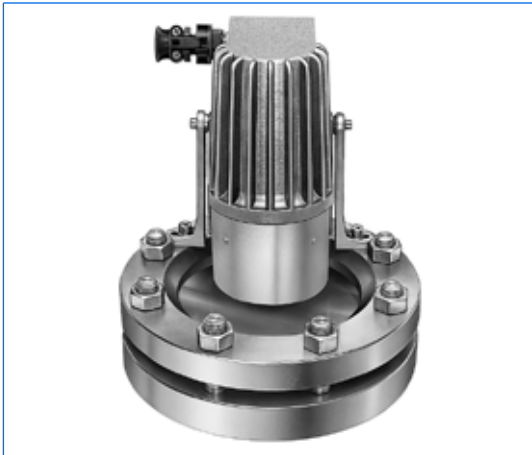
Typ PEL 50 deH X2 B, 230 V, 50 W, Ex d e IIC T4 Gb, Ex t IIIC T130°C Db IP67, Ex II 2 G + D, mit Blendschutz «B», auf Schauglasarmatur nach DIN 28120, DN 150, PN 10, in Anordnung «Licht- und Sichtglas».
