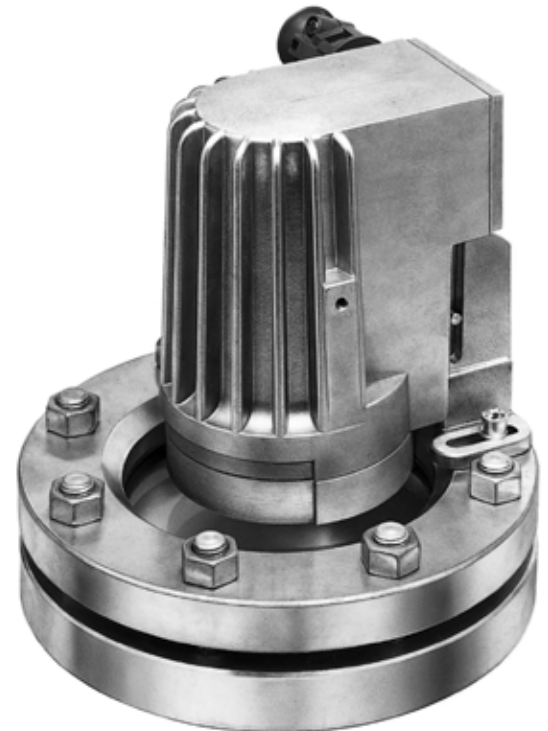
Typ PEL 50 deHSch, Ex d e IIC T4 Gb, Ex t IIIC T130°C Db IP67, Ex II 2 G + D, 230 V, 50 W, auf Schauglasarmatur nach DIN 28120, DN 125, PN 10. Anordnung als «Lichtglas».
