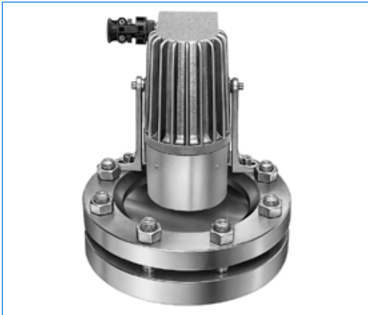
Typ PEL 50 deH X2 B, 230 V, 50 W, Ex de IIC T4, Ex tD A21 IP65 T130°C, Ex II 2 G + D, mit Blendschutz «B», auf Schauglasarmatur nach DIN 28120, DN 150, PN 10, in Anordnung «Licht- und Sichtglas».
