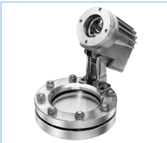
Typ PEL 20 deH Sch, 230 V, 20 W, Ex de IIC T6, Ex tD A21 IP65 T80°C, Ex II 2 G + D, auf Schauglasarmatur nach DIN 28120, DN 125, PN 10, als Anordnung «Lichtglas».
