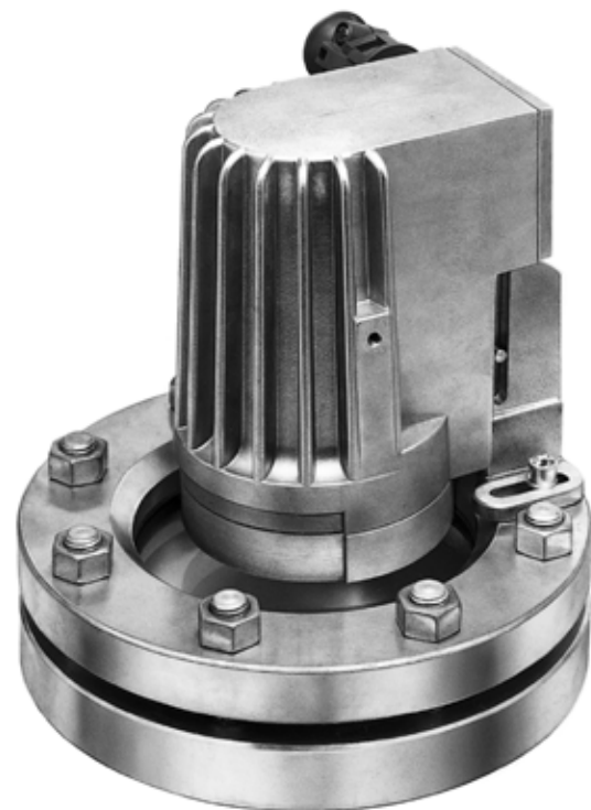
Typ PEL 50 deHSch, Ex de IIC T4, Ex tD A21 IP65 T130°C, Ex II 2 G + D, 230 V, 50 W, auf Schauglasarmatur nach DIN 28120, DN 125, PN 10. Anordnung als «Lichtglas».
