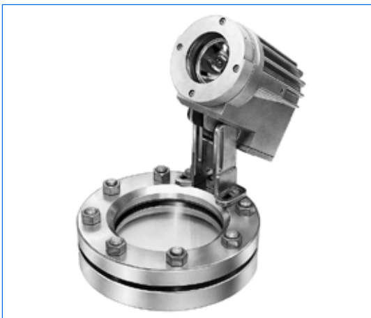
Typ PEL 20 deH Sch, 230 V, 20 W, Ex d e IIC T6 Gb, Ex t IIIC T80°C Db IP67, Ex II 2 G + D, auf Schauglasarmatur nach DIN 28120, DN 125, PN 10, als Anordnung «Lichtglas».
