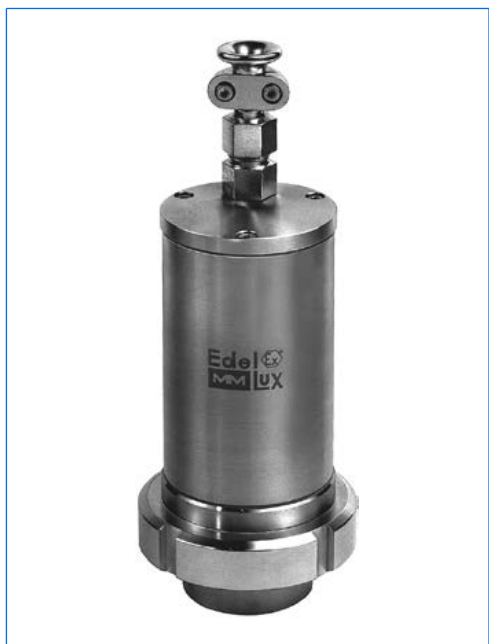
Schauglasleuchte Typ EdelEx 10 dH R50 K1, 10 W, 230 V, Ex d IIC T4 Gb, Ex t IIIC T130°C Db IP67, Ex II 2 G + D, mit Bördelbefestigung «R» auf einer Schraub-Schauglasarmatur ähnlich DIN 11851, PN 6, DN 50.
