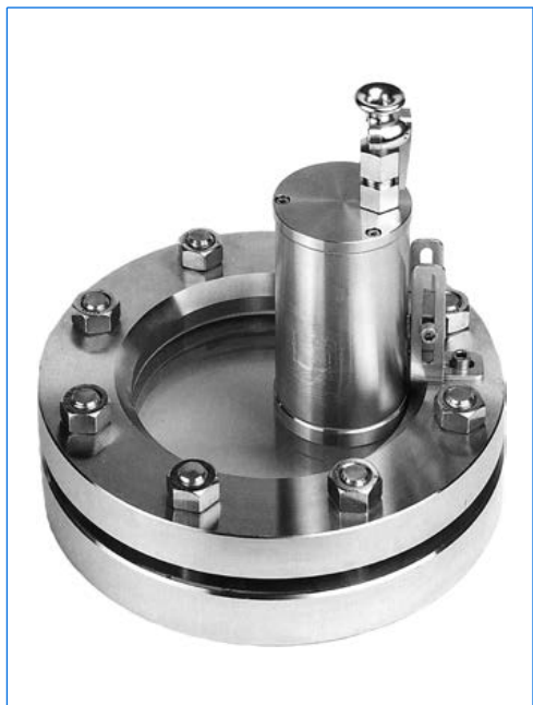
Schauglasleuchte Typ EdelEx 20 dH Sch K1, 20 W, 24 V, Ex d IIC T4 Gb, Ex t IIIC T130°C Db IP67, Ex II 2 G + D, mit Scharnierbefestigung «Sch» auf einer runden Schauglasarmatur nach DIN 28120, PN 10, DN 125.
