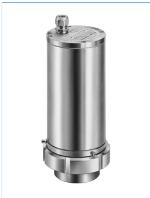
Schauglasleuchte Typ EdelEx G20 dH R 80 K1, 20 W, 230 V, Ex d IIC T5, Ex tD A21 IP65 T95°C, Ex II 2 G + D, mit Bördelbefestigung «R 80» auf einer Schraub-Schauglasarmatur ähnlich DIN 11851, PN 6, DN 80.
