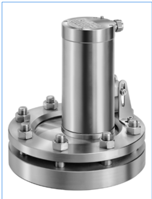
Schauglasleuchte Typ EdelEx 50 dH Sch K2, 50 W, 230 V, Ex d IIC T4, Ex tD A21 IP65 T130°C, Ex II 2 G + D, mit Scharnierbefestigung «Sch» auf einer runden Schauglasarmatur nach DIN 28120, PN 10, DN 150.
