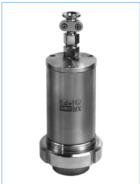
Schauglasleuchte Typ EdelEx d LED R50 K1, ca. 2 W, 24 V, Ex d IIC T6, Ex tD A21 IP65 T80°C, Ex II 2 G + D, mit Bördelbefestigung «R» auf einer Schraub-Schauglasarmatur ähnlich DIN 11851, PN 6, DN 50.
