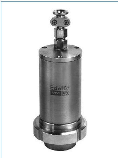
Schauglasleuchte Typ EdelEx d LED R50 K1, 2 W, 24 V AC/DC, Ex d IIC T6 Gb, Ex t IIIC T80°C Db, IP65/67, Ex II 2 G + D, mit Bördelbefestigung «R» auf einer Schraub-Schauglasarmatur ähnlich DIN 11851, PN 6, DN 50.
