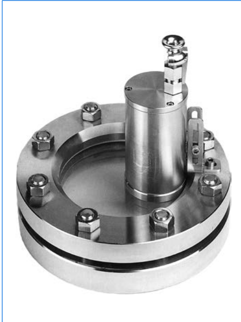
Schauglasleuchte Typ EdelEx d PowerLED Sch K1, 7 W, 24 V AC/DC, Ex d op is IIC T6 Gb, Ex tb IIIC T80°C, IP 65/67, Ex II 2 G + D, mit Scharnierbefestigung «Sch» auf einer runden Schauglasarmatur nach DIN 28120, PN 10, DN 125.
