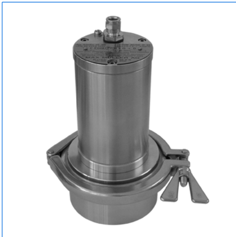
EdelLUX-LED-Schauglasleuchte, Typ EdelEx LED, Ex d IIC T6 Gb, Ex t IIIC T80°C Db IP67, Ex II G + D, auf metallverschmolzenem Schauglas für Triclamp® Klemmverbindungen, DN 50, PN 16
