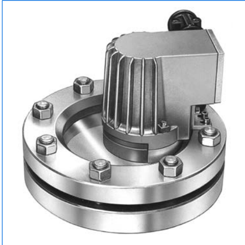
CHEMLUX-LED-Schauglasleuchte, Typ KEL de PowerLED-F W, Ex d e op is IIC T6 Gb, Ex t IIIC T80°C Db IP65/67, Ex II G + D, auf Schauglas nach DIN 28120, DN 125, PN 10
