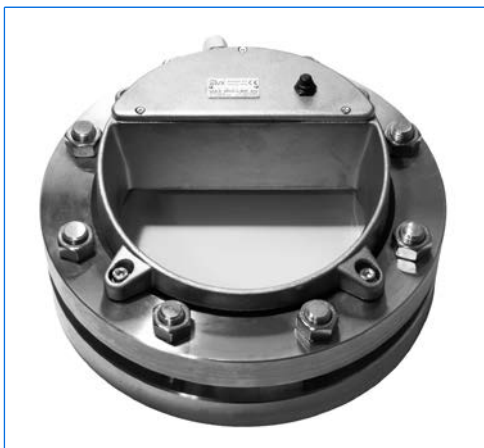
metaLUX-LED-Schauglasleuchte, Typ HL 200 LED, auf Schauglas nach DIN 2810, DN 200, PN 10
