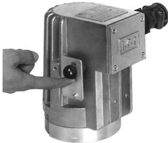
Ex-Leuchte Typ PEL 50 deHV, 50 W, 230 V, Ex d e IIC T4 Gb, Ex t IIIC T130°C Db IP67, Ex II 2 G + D, ausgerüstet mit Timer «V»
