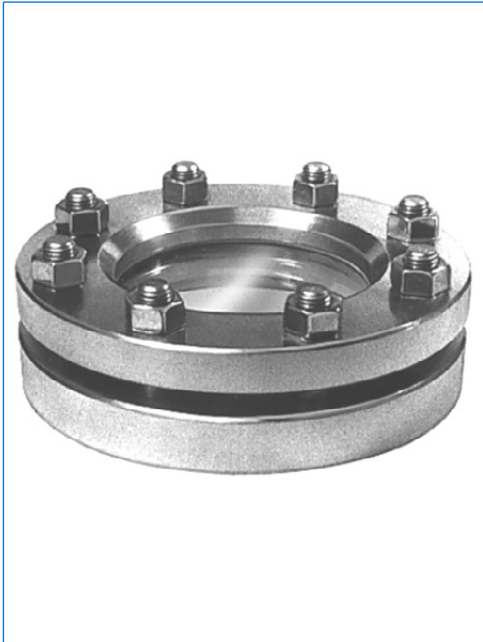
Schauglasarmatur, rund, nach DIN 28120, DN 100, PN 10, mit thermisch vorgespannter Borosilikatglasscheibe nach DIN 7080.
