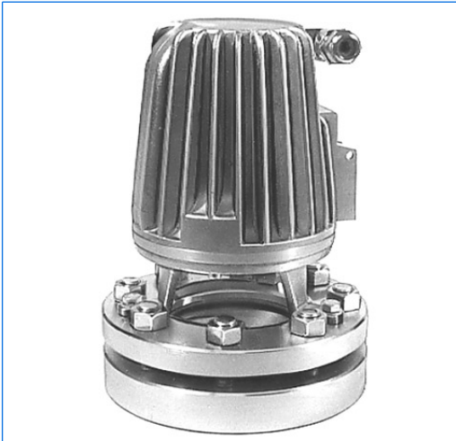
VETROLUX ® -Leuchtschauglas, bestehend aus Schauglasarmatur nach DIN 28120, DN 80, PN 10, mit aufgebauter CHEMLUX ® -Schauglasleuchte, Typ F 20dHNsp, 24 V, 20 W, Ex d IIC T5, Ex tD A21 IP65 T95°C, Ex II 2 G + D
