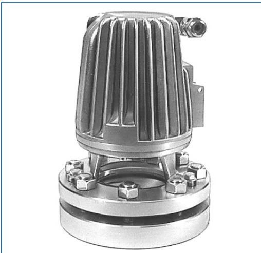
VETROLUX-Leuchtschauglas, bestehend aus Schauglasarmatur nach DIN 28120, DN 80, PN 10, mit aufgebauter CHEMLUX-Schauglasleuchte, Typ F 20dHNsp, 24 V, 20 W, Ex d IIC T5 Gb, Ex t IIIC T95°C Db IP 67, Ex II 2 G + D
