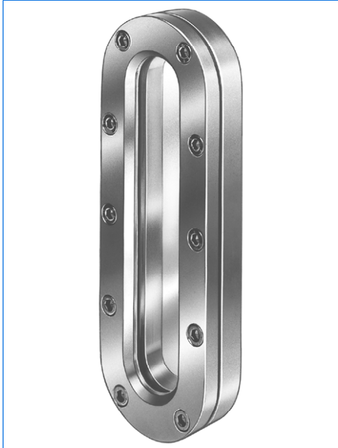
Längsschauglas-Armatur, Typ LSGRR 1.4571-1.4301-2,5-2-SL-8903-KLINGERSil-Silikon. Ausführung mit Sacklöchern, Grundflansch aus 1.4571, Deckflansch aus 1.4301, PN 2,5, Einbaumasse 341 x 116 mm, Glasscheibe nach DIN 8903, Dichtungen aus KLINGERSil C4400 / Silikon.
