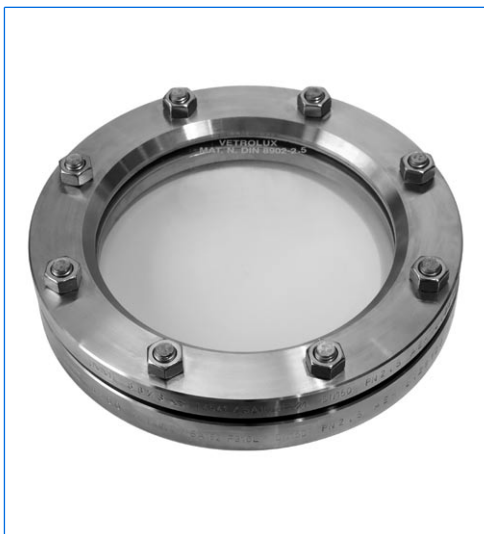
Runde Schauglasarmatur ähnlich DIN 28120, DN 150, PN 2,5, mit thermisch vorgespannter Natronkalkglasscheibe nach DIN 8902
