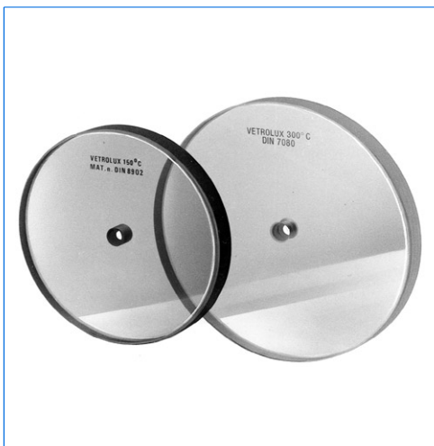
Runde Schauglasplatten mit zentrischer Bohrung \varnothing 10,5 mm ähnlich DIN 8902 resp. DIN 7080, zur Aufnahme von zentrischen Wischern der Typenreihe W/ WD.
