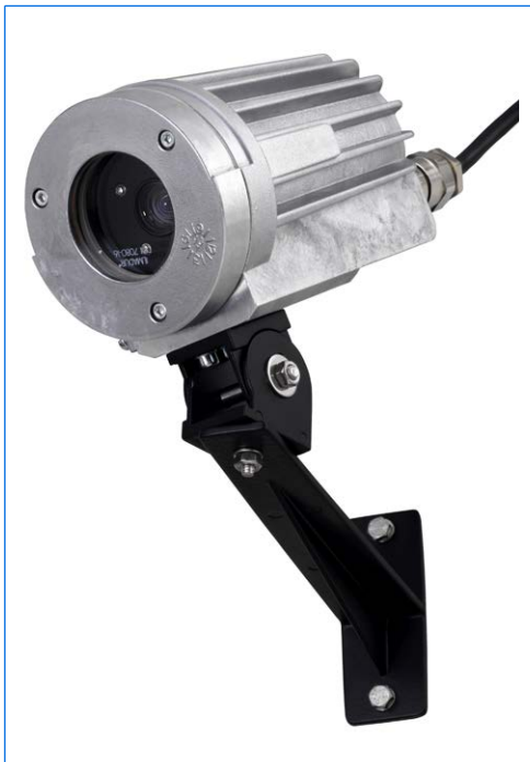
Ex-Kamera Vario in Aluminium-Ausführung, Ex d IIC T6, Ex tD A21 IP67 T80°C, Ex II 2 G + D, mit Wandbefestigung.
