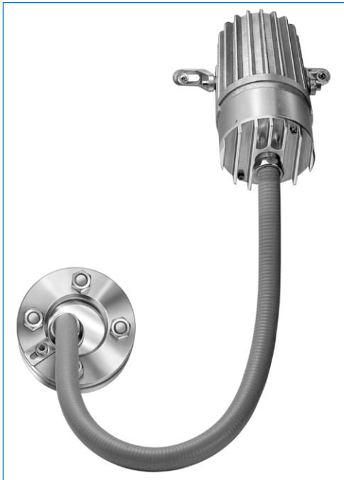
Ex-Fiberoptik-Lichtleiter-Leuchte mit eingebautem Timer «V», Typ fibroLUX® 5035 X1 W2 V, Ex de IIC T4, Ex tD A21 IP65 T130°C, Ex II 2 G + D, 35 W, 230 V, Befestigung der Lichtquelle mit Halterungsfüssen «X1», Befestigung des Lichtleiters mit Universalhalter «W2» auf Schauglas nach DIN 28120, DN 40, PN 10, in Anordnung "Licht und Sicht durch eine Armatur"
