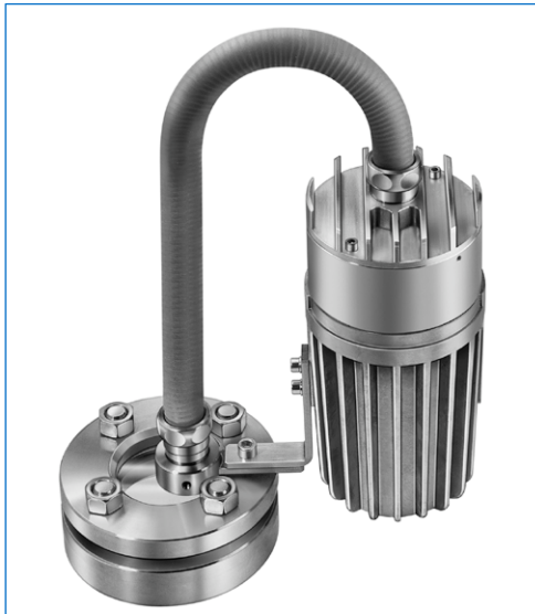
Ex-Fiberoptik-Lichtleiter-Leuchte mit eingebautem Timer «U», Typ fibroLUX® 5035 W W2 U sp, Ex de IIC T4, Ex tD A21 IP65 T130°C, Ex II 2 G + D, 35 W, 12 V DC, Befestigung der Lichtquelle mit Winkel «W», Befestigung des Lichtleiters mit Universalhalter «W2» auf Schauglas nach DIN 28120, DN 40, PN 10
