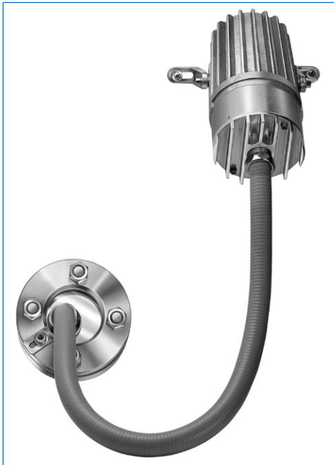
Ex-Fiberoptik-Lichtleiter-Leuchte mit eingebautem Timer «V», Typ fibroLUX® 5035 X1 W2 V, Ex d e IIC T4 Gb, Ex t IIIC T130°C Db IP67, Ex II 2 G + D, 35 W, 230 V, Befestigung der Lichtquelle mit Halterungsfüssen «X1», Befestigung des Lichtleiters mit Universalhalter «W2» auf Schauglas nach DIN 28120, DN 40, PN 10, in Anordnung "Licht und Sicht durch eine Armatur"
