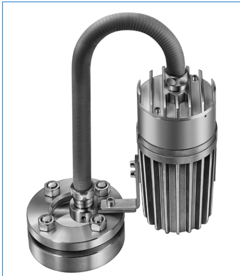
Ex-Fiberoptik-Lichtleiter-Leuchte mit eingebautem Timer «U», Typ fibroLUX® 5035 W2 U sp, Ex d e IIC T4 Gb, Ex t IIIC T130°C Db IP67, Ex II 2 G + D, 35 W, 24 V AC, Befestigung der Lichtquelle mit Winkel «W», Befestigung des Lichtleiters mit Universalhalter «W2» auf Schauglas nach DIN 28120, DN 40, PN 10
