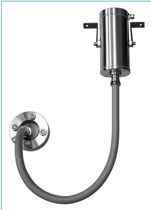
Edelstahl-Ex-Faseroptik-Lichtleiter-Leuchte, Typ fibroLUX® E 5035 X1 W2, Ex d IIC T4, Ex tD A21 IP65 T130°C, Ex II 2 G + D, 35 W, 230 V, Befestigung der Lichtquelle mit Schwenkfüssen «X1», Befestigung des Lichtleiters mit Universalhalter «W2» auf Schauglas nach DIN 28120, DN 40, PN 10, in Anordnung "Licht und Sicht durch eine Armatur"
