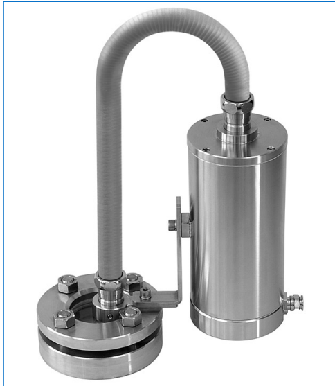
Edelstahl-Ex-Faseroptik-Lichtleiter-Leuchte, Typ fibroLUX® E 5035 W W2 sp, Ex d IIC T4, Ex tD A21 IP65 T130°C, Ex II 2 G + D, 35 W, 12 V DC, Befestigung der Lichtquelle mit Winkel «W», Befestigung des Lichtleiters mit Universalhalter «W2» auf Schauglas nach DIN 28120, DN 40, PN 10
