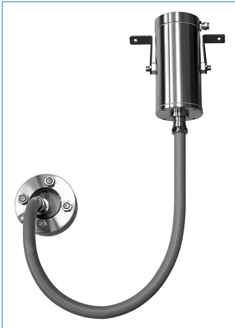
Edelstahl-Ex-Fiberoptik-Lichtleiter-Leuchte, Typ fibroLUX E 5035 X1 W2, Ex d IIC T4 Gb, Ex t IIIC T130°C Db IP67, Ex II 2 G + D, 35 W, 230 V, Befestigung der Lichtquelle mit Schwenkfüssen «X1», Befestigung des Lichtleiters mit Universalhalter «W2» auf Schauglas nach DIN 28120, DN 40, PN 10, in Anordnung »Licht und Sicht durch eine Armatur«
