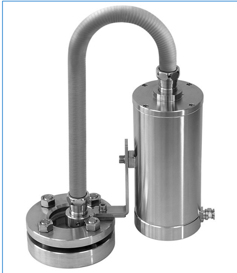
Edelstahl-Ex-Fiberoptik-Lichtleiter-Leuchte, Typ fibroLUX E 5035 W2 sp, Ex d IIC T4 Gb, Ex t IIIC T130°C Db IP67, Ex II 2 G + D, 35 W, 24 V AC, Befestigung der Lichtquelle mit Winkel «W», Befestigung des Lichtleiters mit Universalhalter «W2» auf Schauglas nach DIN 28120, DN 40, PN 10
