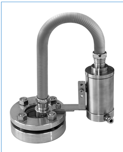
Edelstahl-Ex-Fiberoptik-Lichtleiter-Leuchte, Typ fibroLUX E d PowerLED W2 K2, Ex II 2 G + D, 7 W, 24 V AC / DC, Befestigung der Lichtquelle mit Winkel «W», Befestigung des Lichtleiters mit Universalhalter «W2» auf Schauglas nach DIN 28120, DN 40, PN 10
