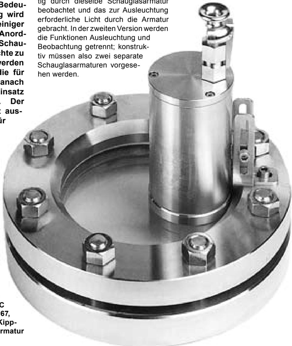
Abb.1 Leuchte Typ EdelEx, vollständig aus rostfreiem Stahl, 20 Watt, 24 Volt, Ex d IIC T4 Gb, Ex t IIIC T130°C Db IP67, Ex II 2 G + D, aufgebaut mit Kipp-scharnier auf eine Schauglasarmatur VETROLUX® nach DIN 28120
