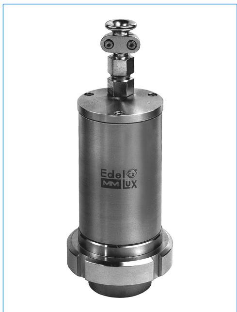
Schauglasleuchte Typ EdelEx 10 dH R50 K1, 10 W, 230 V, Ex d IIC T4, Ex tD A21 IP65 T130°C, Ex II 2 G + D, mit Bördelbefestigung «R» auf einer Schraub-Schauglasarmatur ähnlich DIN 11851, PN 6, DN 50.
