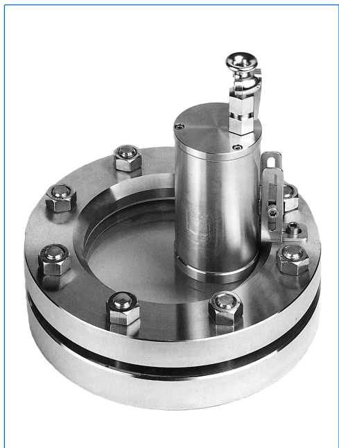
Schauglasleuchte Typ EdelEx 20 dH Sch K1, 20 W, 24 V, Ex d IIC T4, Ex tD A21 IP65 T130°C, Ex II 2 G + D, mit Scharnierbefestigung «Sch» auf einer runden Schauglasarmatur nach DIN 28120, PN 10, DN 125.
