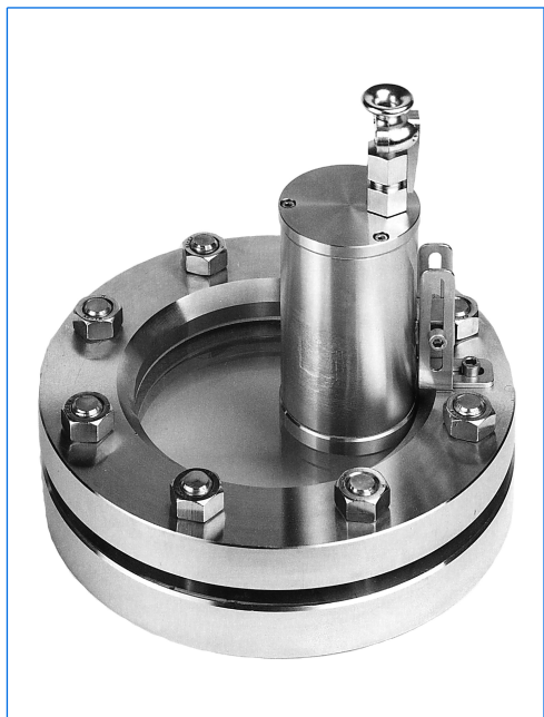
Schauglasleuchte Typ EdelEx d LED Sch K1, ca. 5 W, 100 - 240 V, Ex d IIC T6, Ex tD A21 IP65 T80°C, Ex II 2 G + D, mit Scharnierbefestigung «Sch» auf einer runden Schauglasarmatur nach DIN 28120, PN 10, DN 125.
