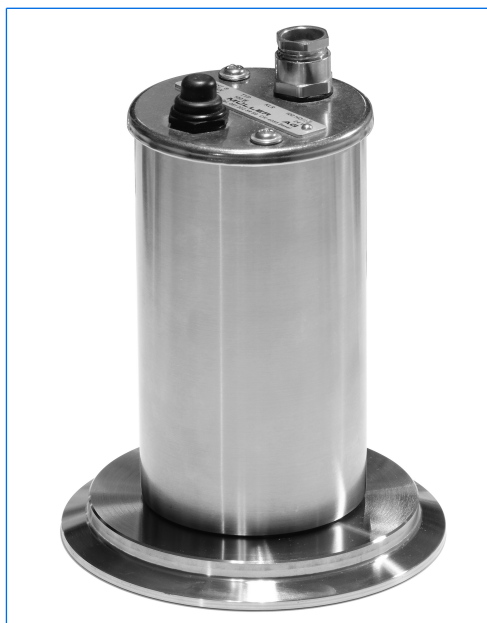
Schauglasleuchte Typ KLR 20 HDA sp , 20 W, 115 V, mit eingebautem Drucktaster «D», auf rundem metallverschmolzenem Schauglas für Klemmverbindungen, DN 100
