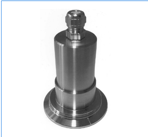
Micro-LED-Schauglasleuchte, Typ MVLR 2 LED, auf metallverschmolzenem Schauglas für Triclamp® Klemmverbindungen, DN 50, PN 16
