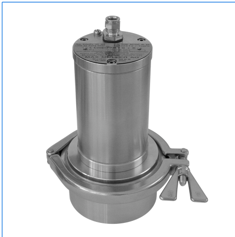
EdelLUX-LED-Schauglasleuchte, Typ EdelEx LED, Ex d II C T6, Ex tD A21 IP 65 T80°C, Ex II G + D, auf metallverschmolzenem Schauglas für Triclamp® Klemmverbindungen, DN 50, PN 16
