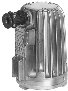
Ex-Leuchte Typ L 20 deHVsp, 20 W, 115 V, Ex d e IIC T5 Gb, Ex t IIIC T95°C Db IP67, Ex II 2 G + D, ausgerüstet mit Timer «V»
