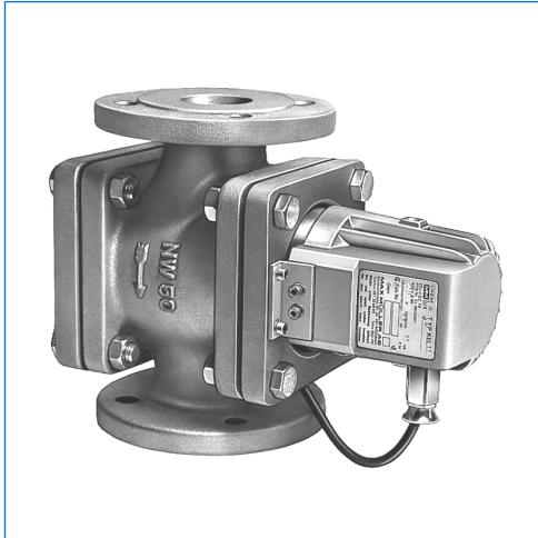
Durchfluss-Schauglasarmatur, Typ FDE 50, mit angebauter Schauglasleuchte, Typ FKEL 5 dH WM, Ex d IIC T6, Ex tD A21 IP65 T80°C, Ex II 2 G + D, 230 V, 5 W, mit Opalglas «M»
