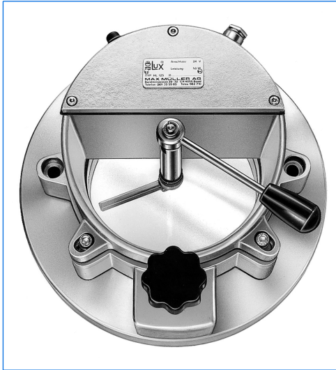
Klappschauglas-Armatur VETROLUX® mit Beleuchtung, Typ KSGB 125, Anschluss 24 V, Leistung 50 oder 100 W, mit eingebautem Scheibenwischer, Baureihe W.
