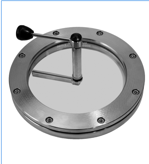
Runde Schauglasarmatur, DN 150, PN 0, mit thermisch vorgespannter Natronkalkglasscheibe nach DIN 8902, mit eingebautem Scheibenwischer, Baureihe W, Wischblatt Silikon
