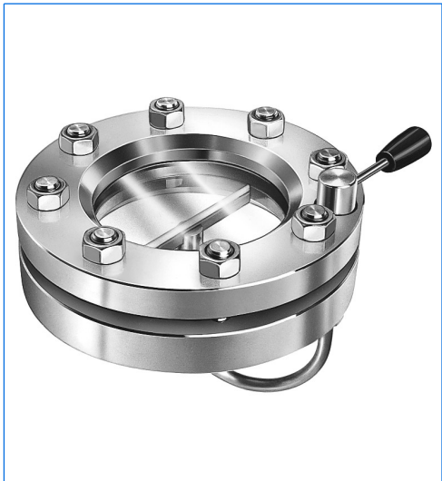
Scheibenwischer-System WS, eingebaut in eine VETROLUX®-Schauglasarmatur nach DIN 28120, DN 100, PN 10.
