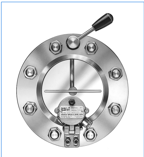
Scheibenwischer-System WS, eingebaut in eine VETROLUX®-Schauglasarmatur nach DIN 28120, DN 100, PN 10, mit auf der Armatur aufgebauter miniLUX®-Schauglasleuchte, Typ KVL 50 HDSch, 24 V, 50 W, für die Kombination «Licht und Sicht durch eine Armatur».
