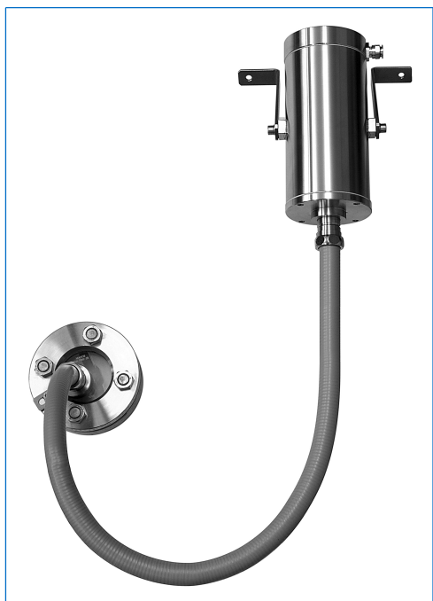
Edelstahl-Ex-Fiberoptik-Lichtleiter-Leuchte, Typ fibroLUX® E 5035 X1 W2, Ex d IIC T4, Ex tD A21 IP65 T130°C, Ex II 2 G + D, 35 W, 230 V, Befestigung der Lichtquelle mit Schwenkfüssen «X1», Befestigung des Lichtleiters mit Universalhalter «W2» auf Schauglas nach DIN 28120, DN 40, PN 10, in Anordnung "Licht und Sicht durch eine Armatur"
