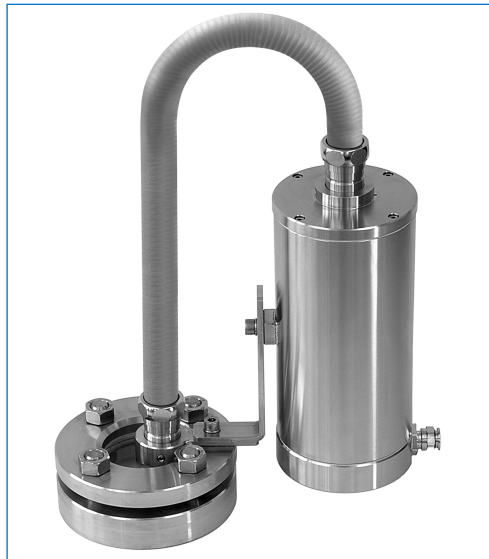
Edelstahl-Ex-Fiberoptik-Lichtleiter-Leuchte, Typ fibroLUX® E 5035 W W2 sp, Ex d IIC T4, Ex tD A21 IP65 T130°C, Ex II 2 G + D, 35 W, 12 V DC, Befestigung der Lichtquelle mit Winkel «W», Befestigung des Lichtleiters mit Universalhalter «W2» auf Schauglas nach DIN 28120, DN 40, PN 10
