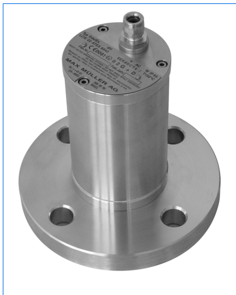
Schauglasleuchte Typ EdelEx STERI-LINE 20 dH, 24 V, 20 W, Ex d IIC T4, Ex tD A21 IP65 T130°C, Ex II 2 G + D, auf metallverschmolzenem Schauglasflansch
