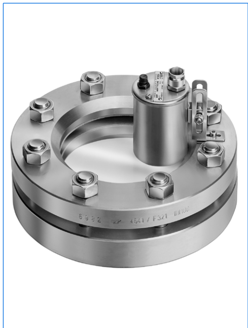
Schauglasleuchte Typ BKVLR LED DSch, 24 V, mit eingebautem Drucktaster «D», auf runder Schauglasarmatur nach DIN 28120, DN 100, PN 10, in Anordnung «Sicht und Licht durch eine Armatur».
