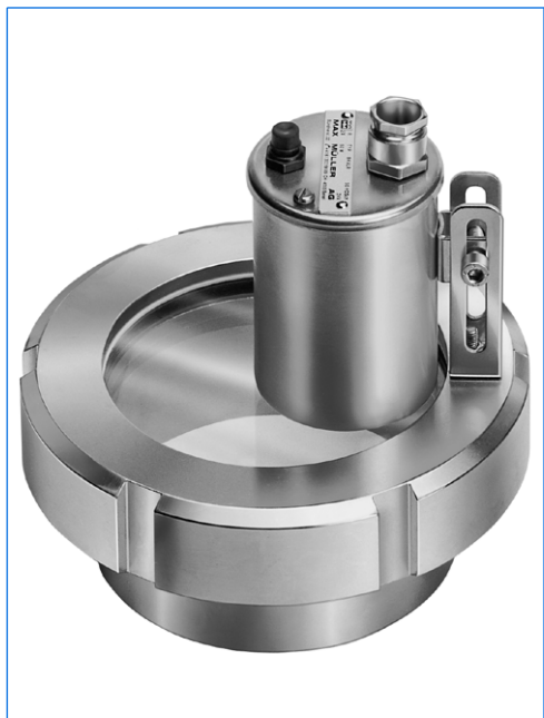
Schauglasleuchte Typ BKVLR LED DSch1, 24 V, mit eingebautem Drucktaster «D», auf Schraub-Schauglasarmatur ähnlich DIN 11851, DN 100, PN 6, in Anordnung «Sicht und Licht durch eine Armatur».
