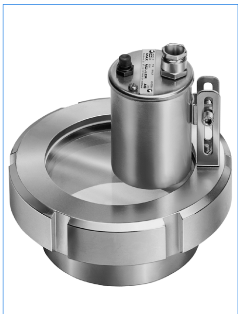
Schauglasleuchte Typ BKVLR 50 HDSch1, 50 W, 24 V, mit eingebautem Drucktaster «D», auf Schraub-Schauglasarmatur ähnlich DIN 11851, DN 100, PN 6, in Anordnung «Sicht und Licht durch eine Armatur».
