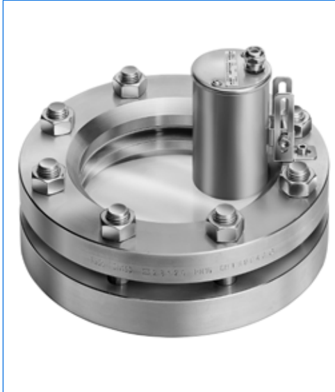
Schauglasleuchte Typ KLR 50 HSch, 50 W, 24 V, auf runder Schauglasarmatur nach DIN 28120, DN 100, PN 10, in Anordnung «Sicht und Licht durch eine Armatur».
