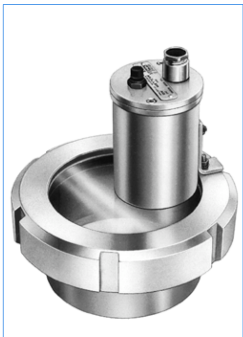
Schauglasleuchte Typ KVLR 50 HDW1, 50 W, 24 V, mit eingebautem Drucktaster «D», auf Schraub-Schauglasarmatur ähnlich DIN 11851, DN 100, PN 6, in Anordnung «Sicht und Licht durch eine Armatur».
