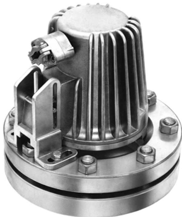
Type F 20 dHSchU, Ex d IIC T5, Ex tD A21 IP65 T95°C, Ex II 2 G + D, ampoule halogène, 230 V, 20 W, temporisation «U» incorporée, sur hublot selon DIN 28120, DN 125, PN 10, fixation par charnière «Sch».
