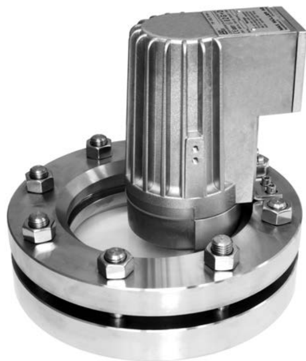
Type HEL 50 deHW, Ex d e IIC T3 Gb, Ex t IIIC T195°C Db / IP67, Ex II 2 G + D, 230 V, 50 W, version halogène, monté sur un hublot selon DIN 28120, DN 125, PN 10. Montage en version «vue et éclairage par un seul hublot».
