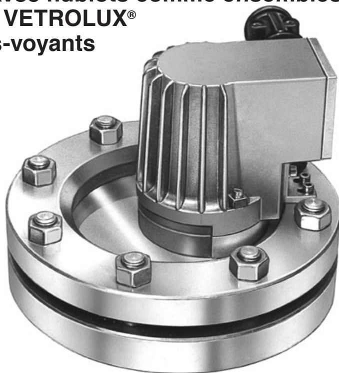
Type KEL 20 deH W, Ex de IIC T4, Ex tD A21 IP65 T130°C, Ex II 2 G + D, 230 V, 20 W, monté sur un hublot selon DIN 28120, DN 125, PN 10. Montage en version «vue et éclairage par un seul hublot».
