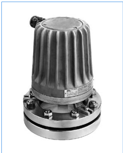
Projecteur de haute performance type 100 deHN, 100 W, 24 V, Ex de IIC T4, Ex tD A21 IP65 T130°C, Ex II 2 G + D, fixation par trépied «N», monté sur hublot selon DIN 28120, PN 10, DN 125
