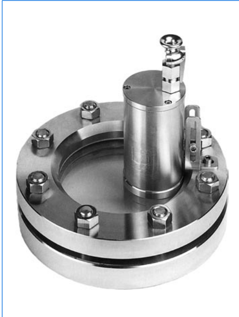
Projecteur type EdelEx 20 dH Sch K1, 20 W, 230 V, Ex d IIC T4, Ex tD A21 IP65 T130°C, Ex II 2 G + D, avec fixation de charnière «Sch» sur hublot rond selon DIN 28120, PN 10, DN 125.
