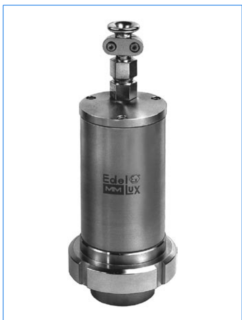
Projecteur type EdelEx d LED R50 K1, env. 2 W, 24 V, Ex d IIC T6, Ex tD A21 IP65 T80°C, Ex II 2 G + D, avec fixation par disque à col étiré «R» sur hublot à visser similaire à DIN 11851, PN 6, DN 50.
