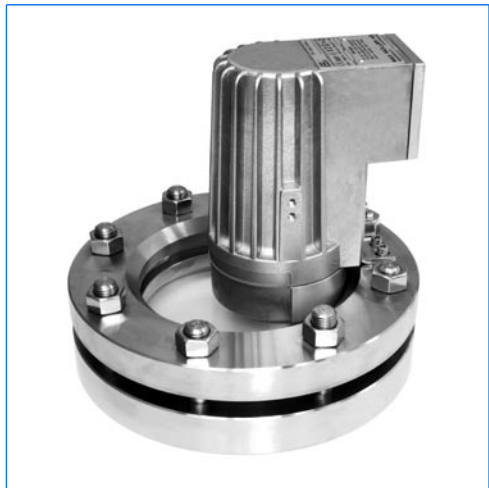
Projecteur LED CHEMLUX, type HEL de LED-F W, Ex de II C T6, Ex tD A21 IP 65 T80°C, Ex II G + D, sur hublot selon DIN 28120, DN 125, PN 10
