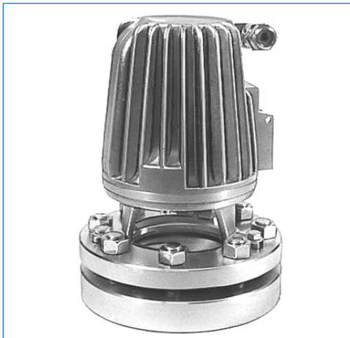
Ensemble éclairant-voyant VETROLUX, se composant d'un hublot selon DIN 28120, DN 80, PN 10, avec projecteur CHEMLUX, type F 20dHNsp, 24 V, 20 W, Ex d IIC T5 Gb, Ex t IIIC T95°C Db IP 67, Ex II 2 G + D
