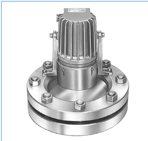
Ensemble éclairant-voyant VETROLUX, se composant d'un hublot selon DIN 28120, DN 150, PN 10, avec projecteur CHEMLUX, type KEL 20 deH Sch B, 230 V, 20 W, Ex d e IIC T4 Gb, Ex t IIIC T130°C Db IP67, Ex II 2 G + D, avec pare-reflets «B», en version «vue et éclairage par un seul hublot»
