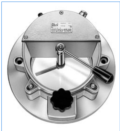
Hublot éclairant-voiant, type KSGB 125, tension d'alimentation 24 V, puissance 50 ou 100 Watts, avec essuie-glace de la gamme W.
