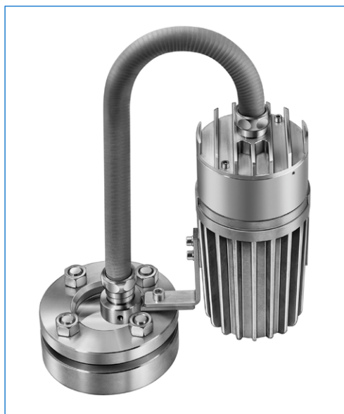
Projecteur adf à fibre optique avec temporisation intégrée «U», type fibroLUX® 5035 W W2 U sp, Ex de IIC T4, Ex tD A21 IP65 T130°C, Ex II 2 G + D, 35 W, 12 V DC, fixation de la source lumineuse avec équerre «W», fixation de la fibre optique par collier «W2» sur hublot selon DIN 28120, DN 40, PN 10
