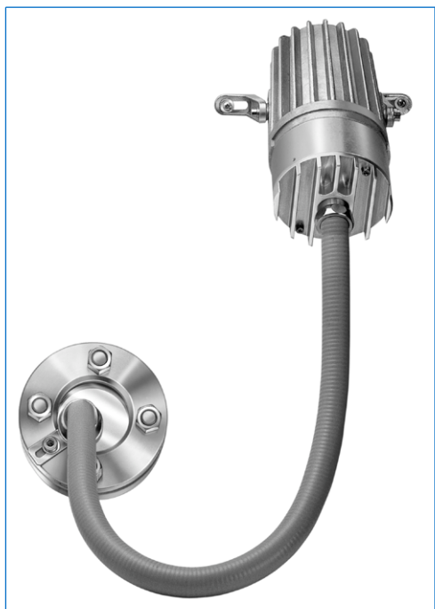
Projecteur adf à fibre optique avec temporisation «V», type fibroLUX® 5035 X1 W2 V, Ex de IIC T4, Ex tD A21 IP65 T130°C, Ex II 2 G + D, 35 W, 230 V, fixation de la source lumineuse par pieds «X1», fixation de la fibre optique avec collier «W2» sur hublot selon DIN 28120, DN 40, PN 10
