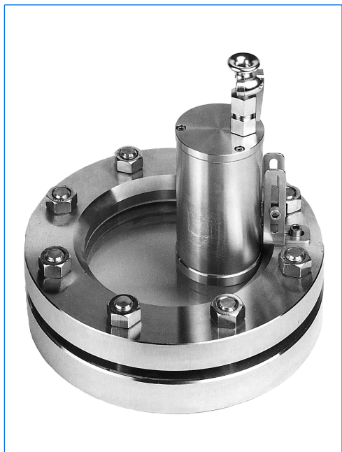
Projecteur type EdelEx d LED Sch K1, env. 5 W, 100 - 240 V, Ex d IIC T6, Ex tD A21 IP65 T80°C, Ex II 2 G + D, avec fixation de charnière «Sch» sur hublot rond selon DIN 28120, PN 10, DN 125.
