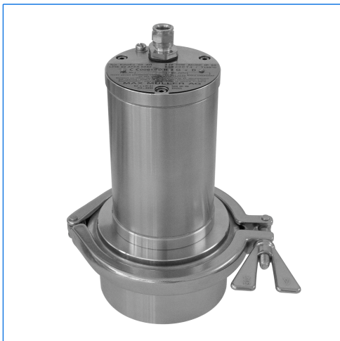
Projecteur LED EdelLUX, type EdelEx LED, Ex d II C T6, Ex tD A21 IP 65 T80°C, Ex II G + D, monté sur hublot à verre moulé pour raccords Triclamp®, DN 50, PN 16
