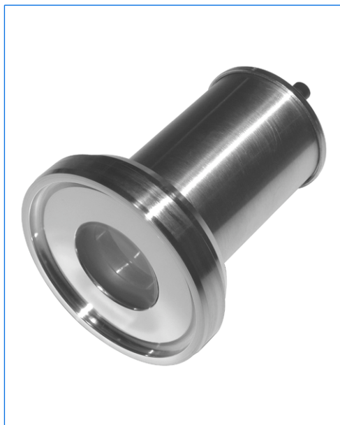
Proiettore miniLUX STERI-LINE, tipo BKVLR DA LED, ca. 2 W, 24 V, montato su oblò con vetro sigillato secondo DIN 11864-1
