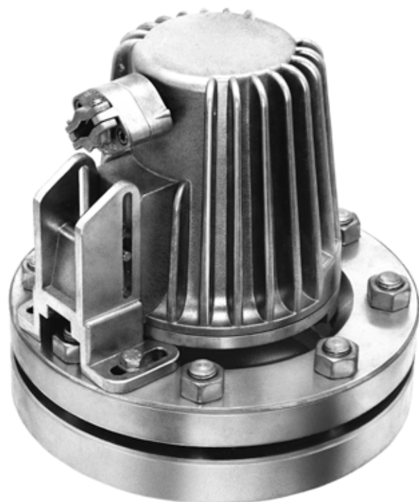
Proiettore tipo F 20 dH Sch U, Ex d IIC T5, Ex tD A21 IP65 T95°C, Ex II 2 G + D, lampadina alogena, 230 V, 20 W, temporizzatore «U» incorporato, montato su oblò secondo DIN 28120, DN 125, PN 10
